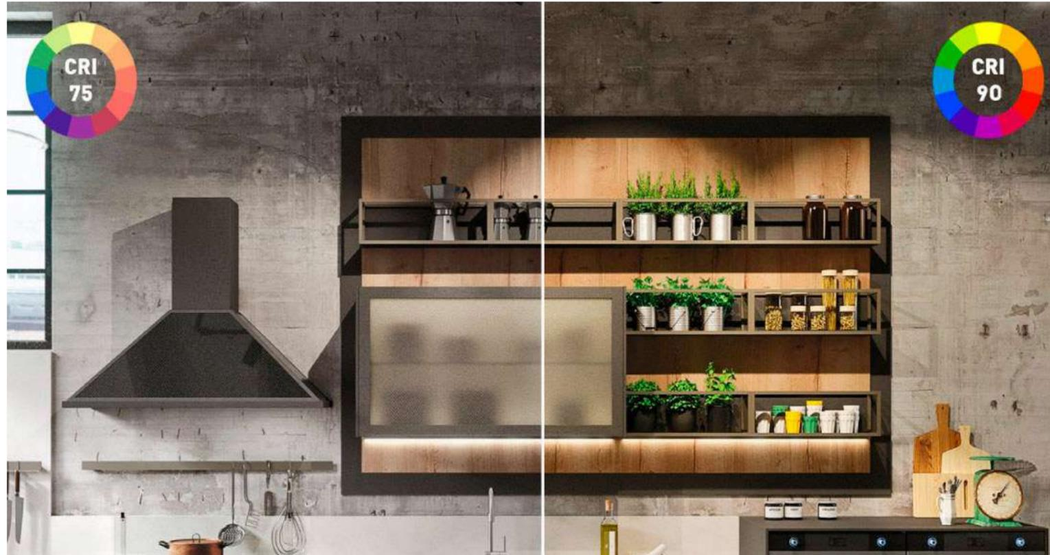
L'indice di resa cromatica, spesso indicato con l'acronimo CRI (Color Rendering Index) varia su una scala da 0 a 100, dove 0 è il valore minimo e 100 è il valore massimo, ovvero la resa cromatica della luce naturale del Sole.
